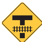
Đường sắt phía trước Nút Giao Chữ "T"
